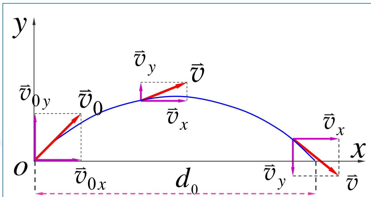
$$x = v_0 \cos\alpha \cdot t \quad y = v_0 \sin\alpha \cdot t - \frac{1}{2} g t^2$$
