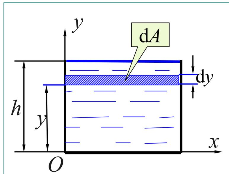
**解** 设水深  $h$ ，坝长  $L$ ，在坝面上取面积元  $dA = Ldy$  作用在此面积元上的力
