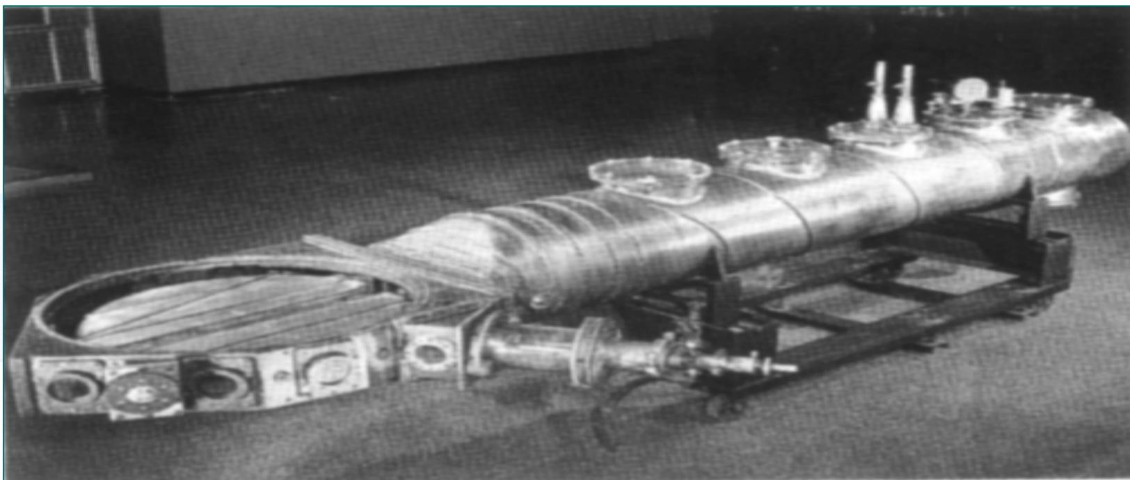
1932年劳伦斯研制第一台回旋加速器的D型室。此加速器可将质子和氘核加速到1MeV的能量，为此1939年劳伦斯获得诺贝尔物理学奖。
