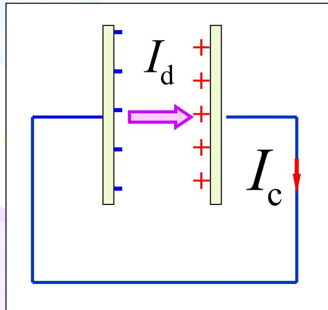
通过电场中某一截面的位移电流等于通过该截面电位移通量对时间的变化率。
